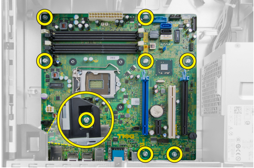
5. ارفع لوحة النظام وقم بإزالتها من الهيكل.
