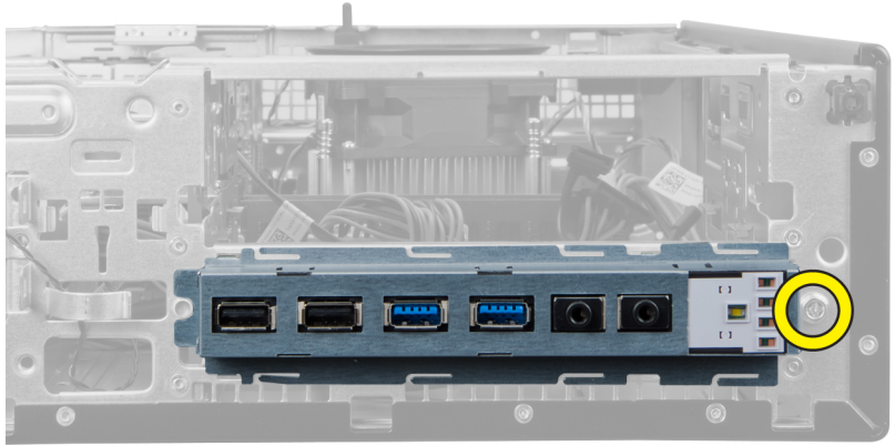
7. أخرج لوحة الإدخال/الإخراج باتجاه الجانب الأيسر من الكمبيوتر لتحريره، واسحب للوحة الإدخال/الإخراج (I/O) مع الكبل الخاص بها إلى خارج الكمبيوتر.
